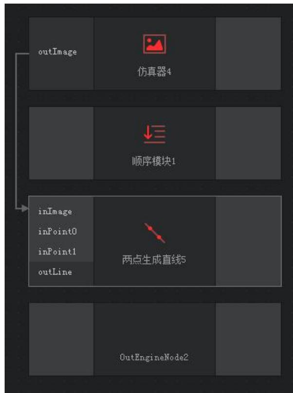
若按照上图进行配置工程，则执行顺序是：先执行“仿真器”，再执行“顺序模块”内的算子，等“顺序模块”内的算子都执行完了以后，会跳出顺序模块，再执行“两点生成直线”算子。
