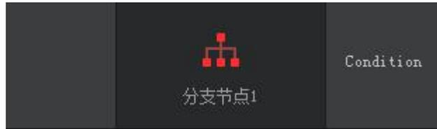
当条件分支创建以后，在“分支节点”上会产生 **Condition** 的输入参数，根据输入参数的不同，会进入不同的条件分支。对分支内的算子进行处理。
