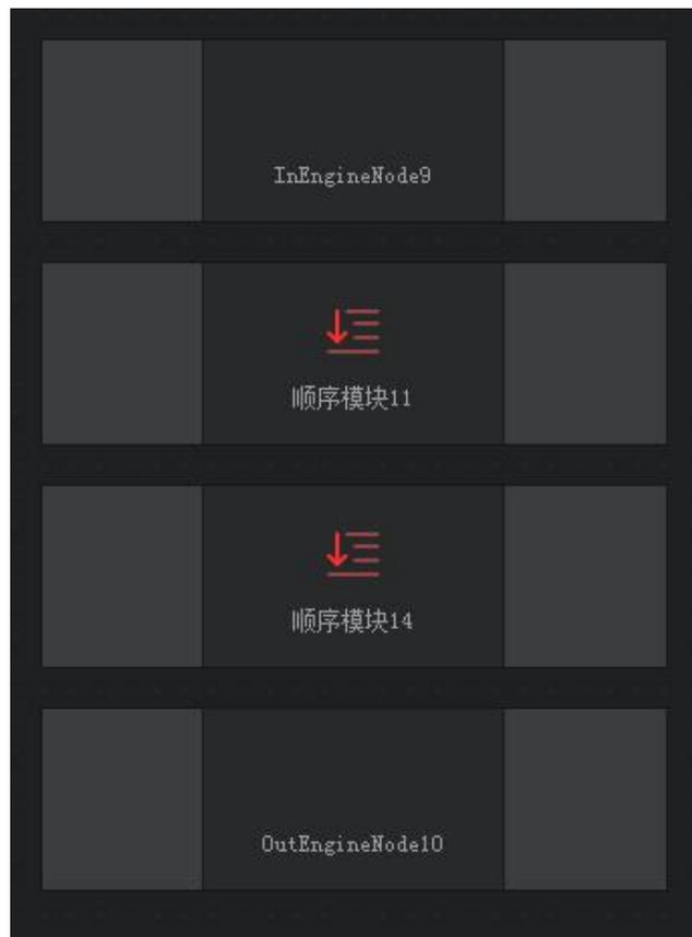
在多任务同步模块添加两个顺序模块，在顺序模块中添加需要添加的算子，点击运行后，两个顺序模块因为也是属于算子，所以将会在不同的线程中一起运行，保证了两个顺序模块同步多线程工作。
