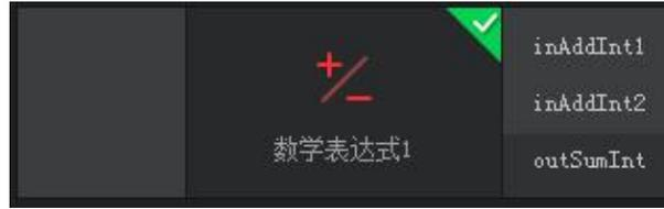
上述配置会将两个输入参数 `inAddInt1` 和 `inAddInt2` 做加法，然后将值输出到输出参数 `outSumInt` 中。
